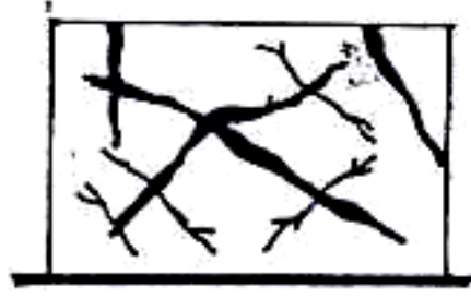
Şekil 3.33. Derin ve Yoğun Çatlaklar
