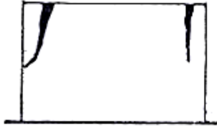
Şekil 3.32. Kenarlarda Çatlak Açılması
